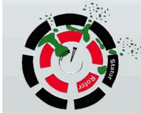
Figura 2.11 Principio de operación del homogenizador rotor estator (Madrid et al., 2001)
