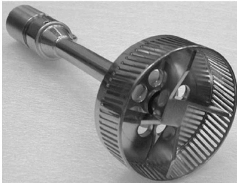
*Figura 2.7 Homogenizador rotor estator, previo al nuevo diseño*
