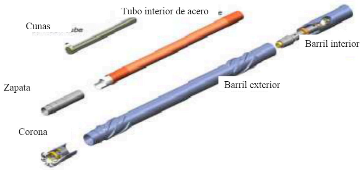
Figura 30. Arreglo de tubos para el corte de núcleos.
