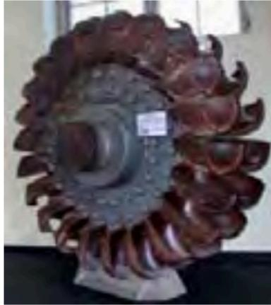
Figura. 3.3 Turbina Pelton.
