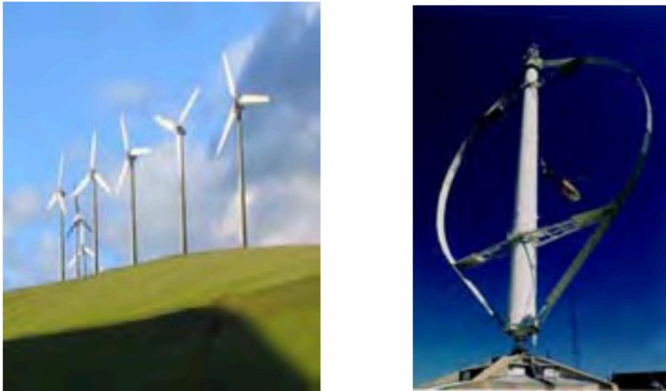
**Figura. 1.23 Generadores eólicos, de eje vertical y eje horizontal.**
