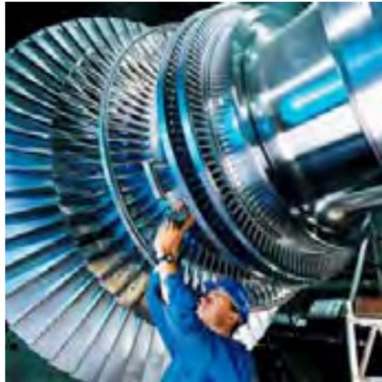
Figura. 3.11 Rotor de una Turbina de Vapor.
