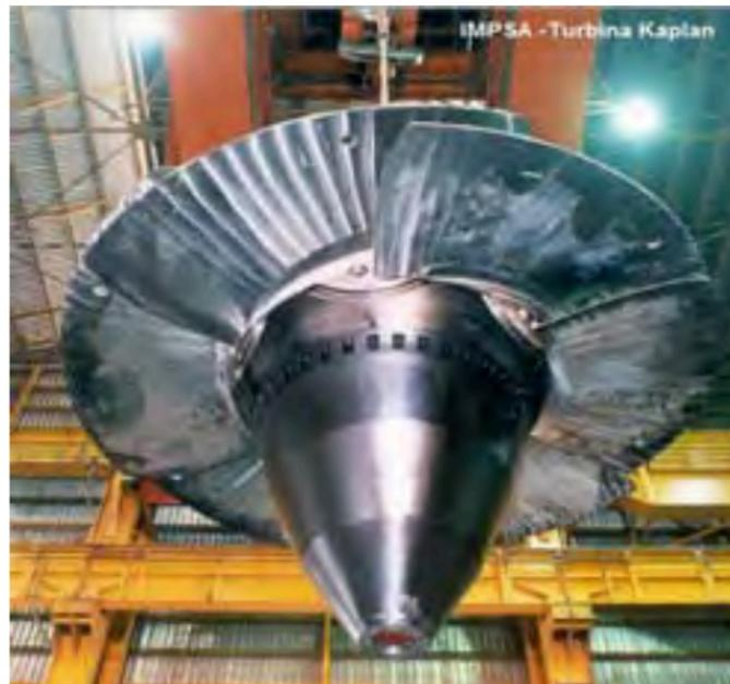
**Figura. 3.9** Turbina Kaplan.
