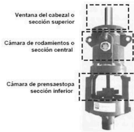
Figura 3.14. Partes del cabezal
