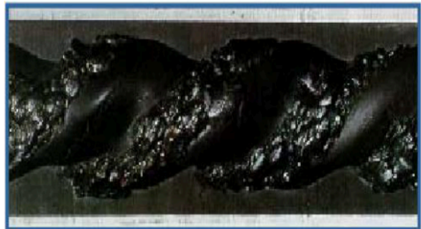
Figura 6.8. Estator dañado por presión excesiva
