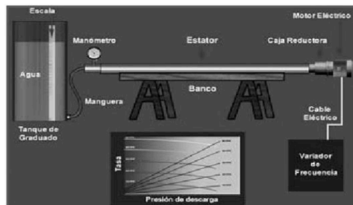
Figura 6.2. Esquema de verificación de la capacidad hidráulica
