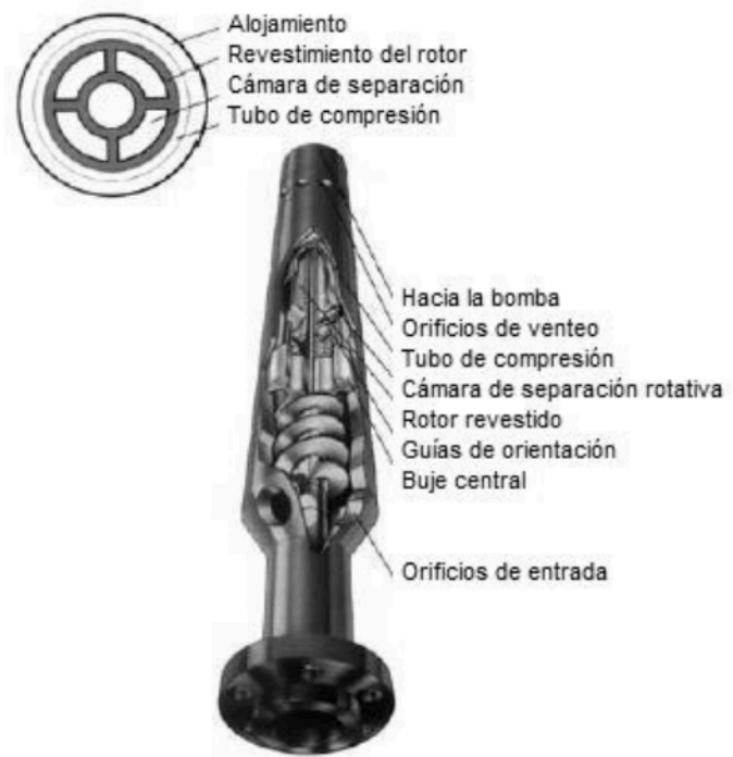
Figura 3.24. Separador de gas dinámico
