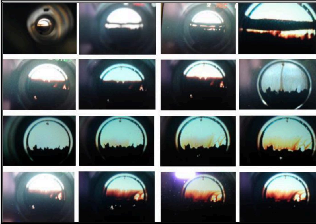
Figura 4.10 Determinación de la PMM a través de una mirilla para alta presión.
