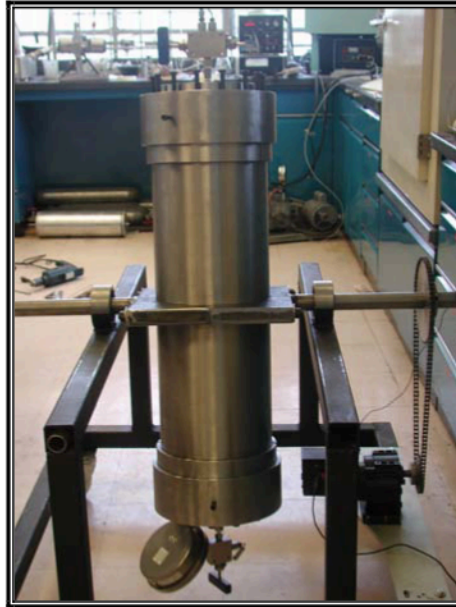
Figura 4.3 Celda de mezclado.
