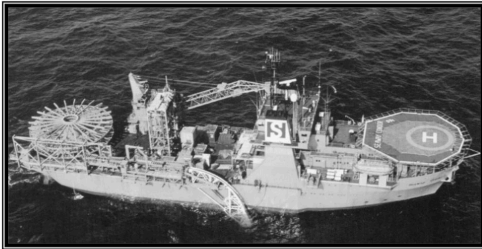
Figura III.8 Tendido de la tubería con barco con riel horizontal
