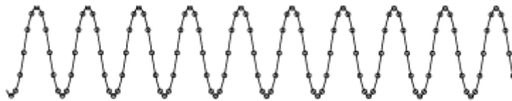
Figura III.3a Señal adecuadamente muestreada
