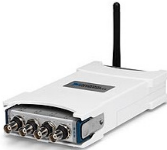
Figura B.3 Ejemplo de Data Logger Wifi
