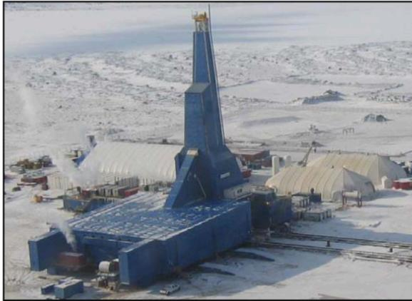
Fig. 6.11. Equipo de perforación Yastreb
