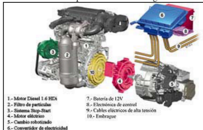
Figura 1.8 Componentes del sistema híbrido diesel-eléctrico.
