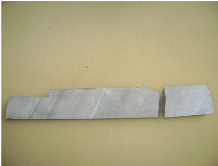
Fig.-4.18. Calizas de color gris claro, presenta intercalaciones con tulitas y calcita así como también calizas de color gris oscuro
