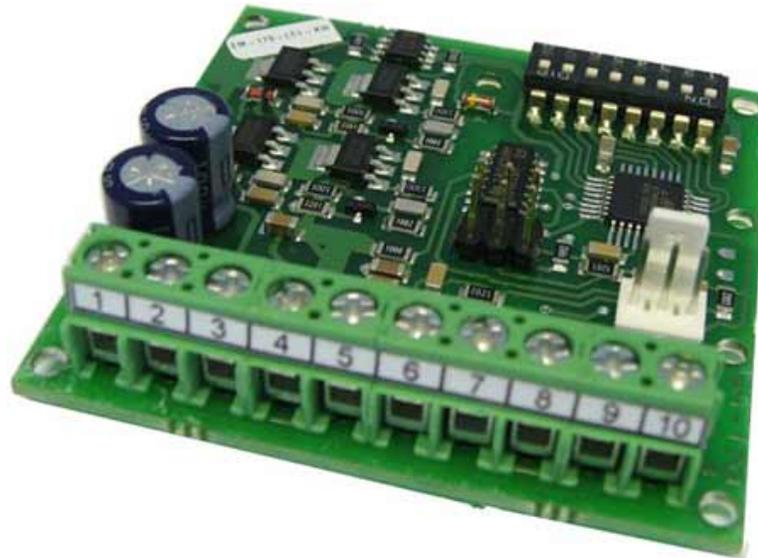
Figura 2.10 Controlador de motor DC EM-170
