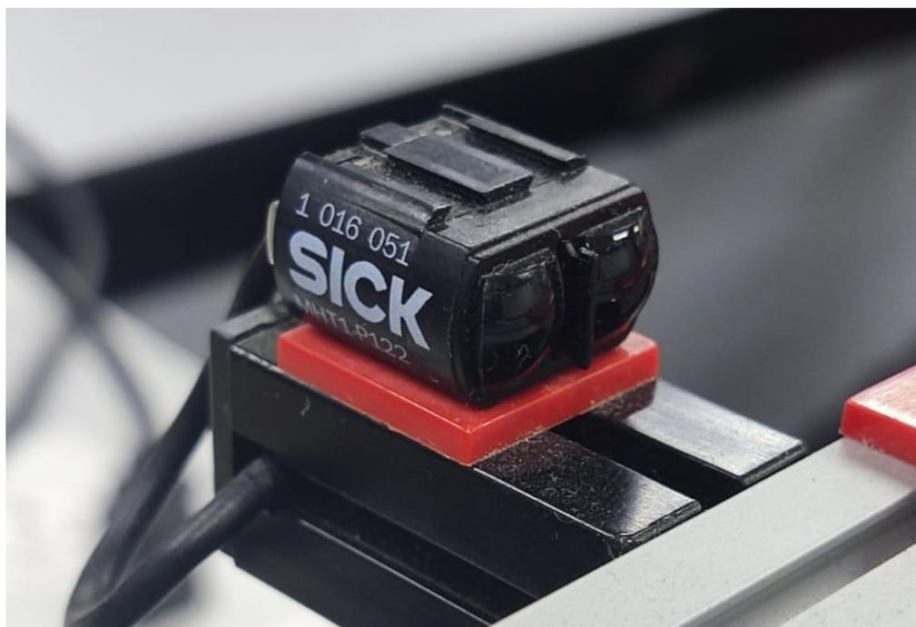
Figura 3.4 Sensor fotoeléctrico SICK
