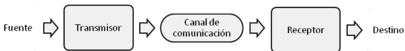
Figura 1.- Diagrama de bloques de un sistema general de telecomunicación.
