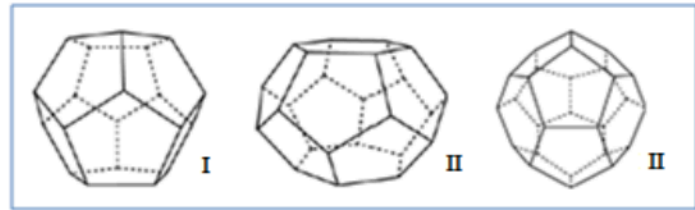
Figura 1.13. Los tres tipos de cavidad presentes en los hidratos con estructuras I y II. (Centre for Gas Hydrate Research at Heriot-Watt University, 2001).
