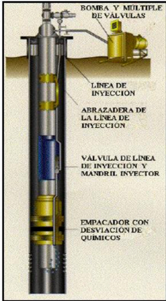
fig.IV.7 Sistema de inyección continua de productos químicos
