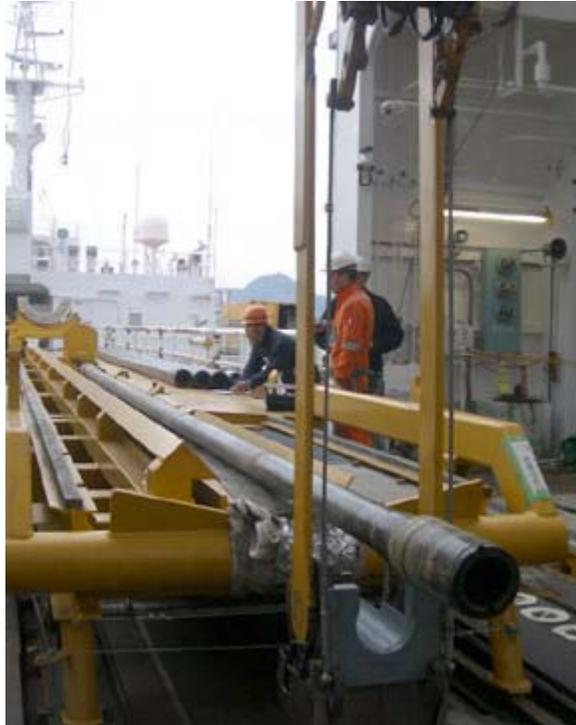
1.25 Sistema hidráulico para subir tubería al piso de perforación.
