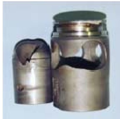
FIG VI.35 Daños causados por la arena
