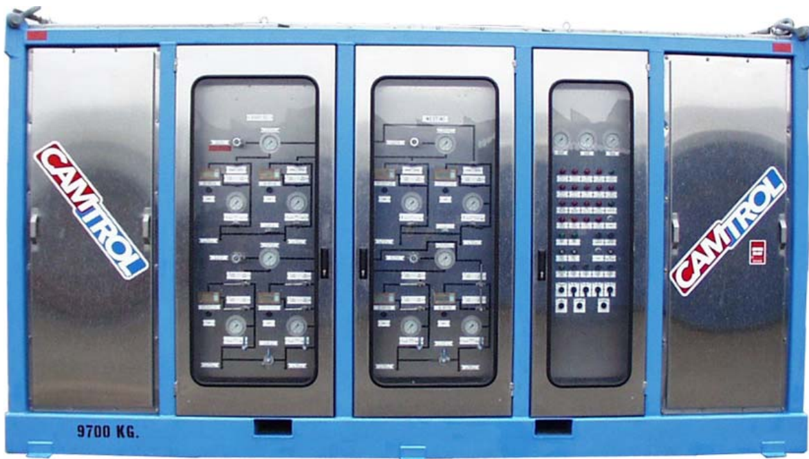
FIG. II.27 Unidad de Potencia hidráulica Propiedad CAMERON
