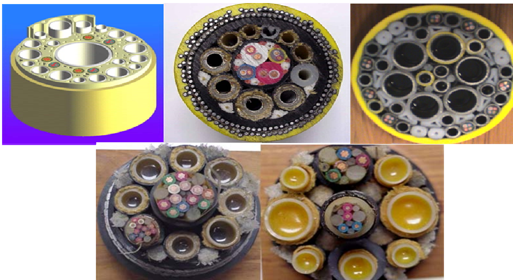
FIG. II.35 Pre-diseño de los umbilicales
