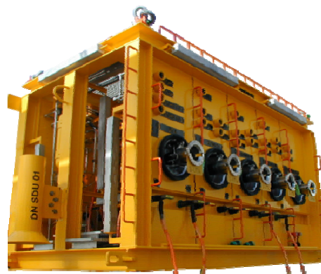
FIG. II.30 Esquema SDU Propiedad CAMERON
