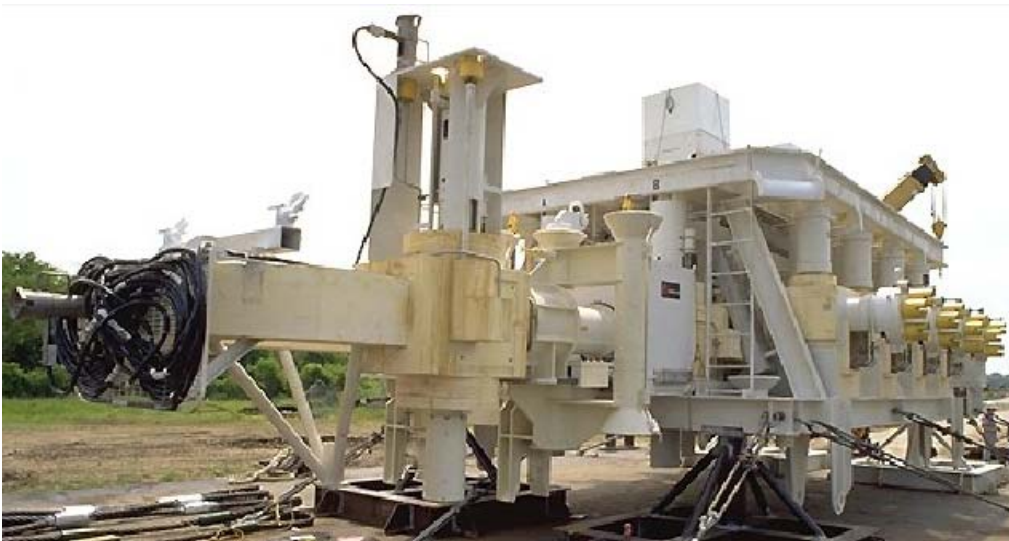
FIG VII.6 template manifold del campo Troika Referencia X
