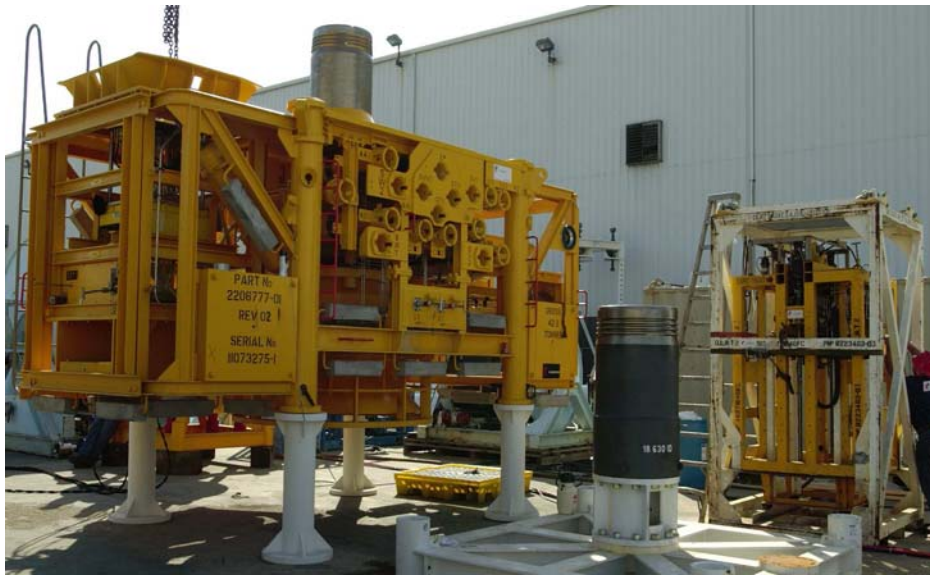
FIG. II.4 Árbol submarino de producción Propiedad CAMERON
