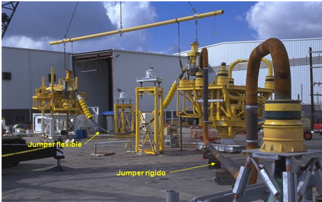
FIG. II.20 Diferentes tipos de JUMPERS Propiedad CAMERON
