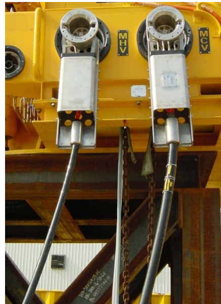
FIG. II.32 Conexión flying Leads Propiedad CAMERON
