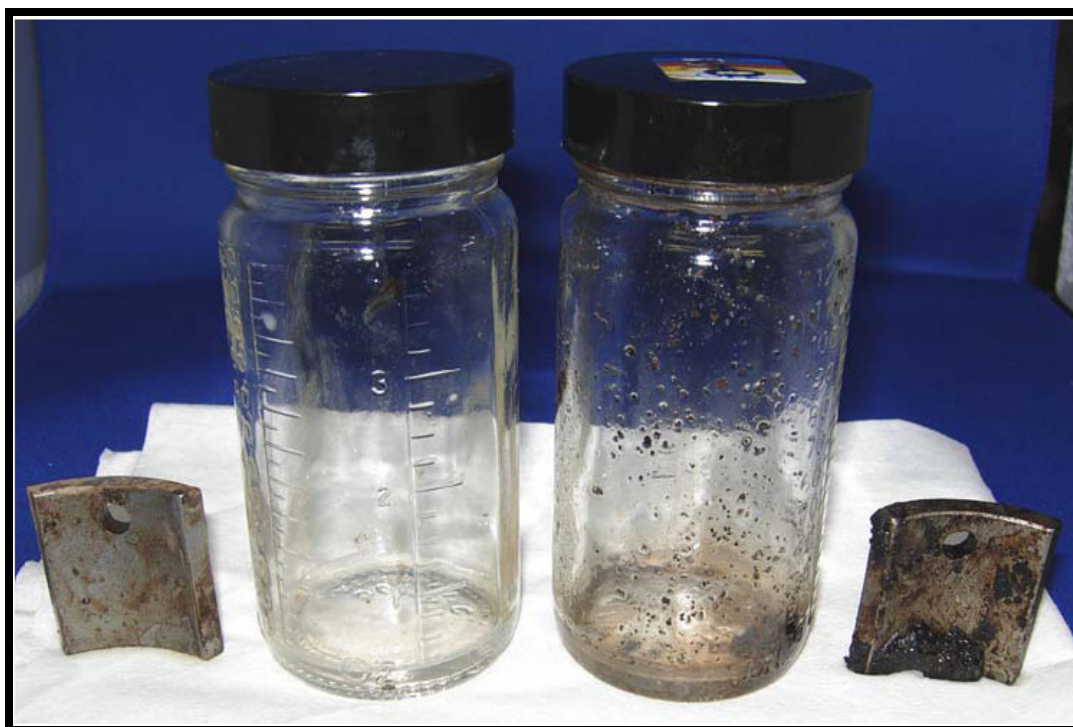
Figura 6.6 Ilustración de las características de mojabilidad del ESS contra el xileno (Frost, 2008) 10 .
