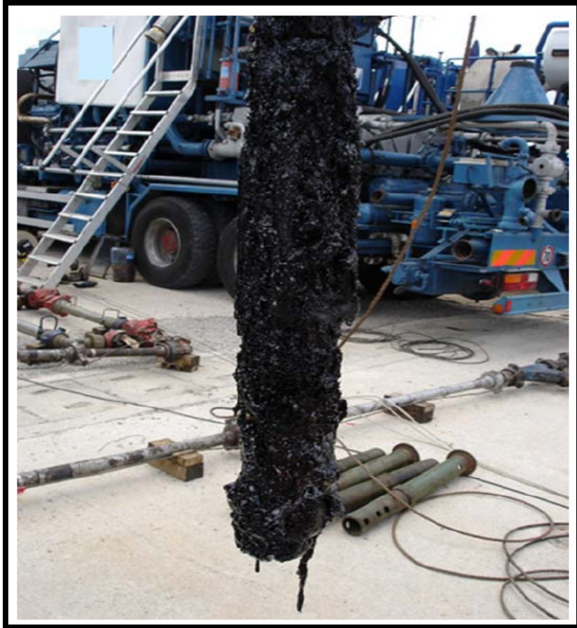
Figura 6.1 Herramientas extraídas del pozo muestran la acumulación de asfaltenos en la tubería flexible durante la operación de lavado (Lightford, 2006) 18 .
