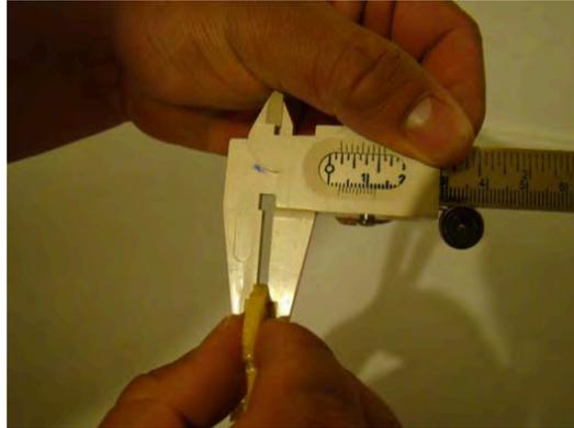
Figura 4.4 Medición con Pie de Rey.
