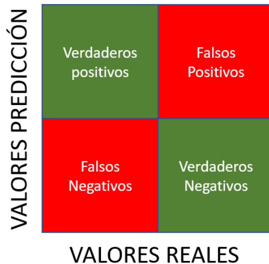
Figura (23) Representación de una matriz de confusión, el número de columnas y filas será equivalente al número de clases que se hayan propuesto para el algoritmo. Referencia [U]
