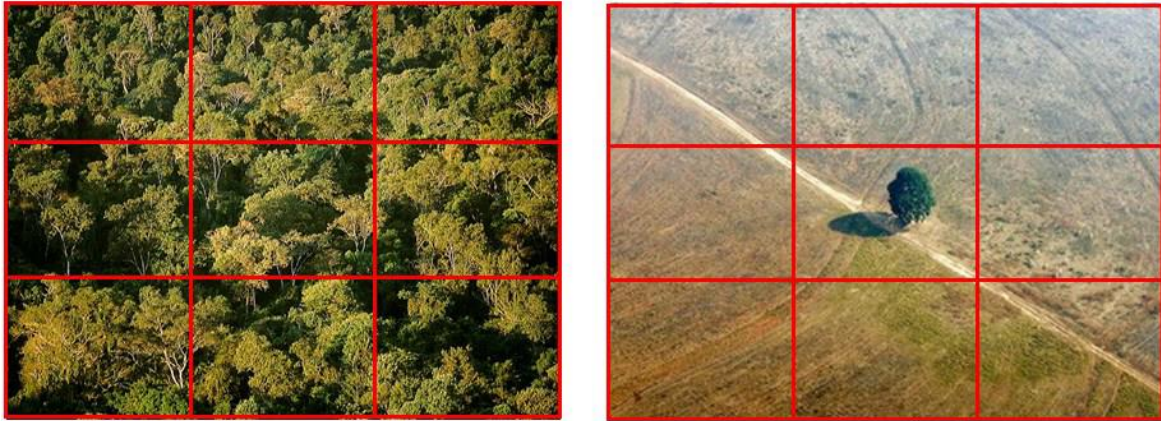
Figura (19) En la imagen de la izquierda los pixeles tienen cobertura vegetal del 100%, en cambio en la imagen de la derecha, el pixel del centro, posee una cobertura del 15% aproximadamente, donde el valor registrado por sensor está fuertemente influenciado por la reflectancia del suelo. Referencia [Q]
