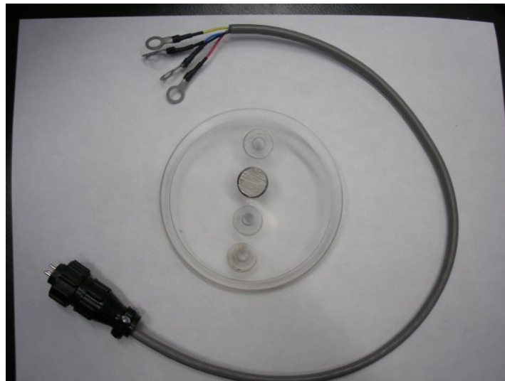
Figura 30. Conector con el cable adaptado mediante zapatas para fijarse con una tuerca a los electrodos.
