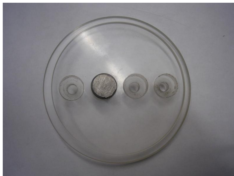
Figura 40. Uno de los electrodos finales, montado sobre la base acrílica de montaje.
