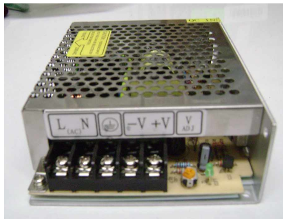
Figura A.7 Fuente de alimentación para la válvula solenoide para exhalación
