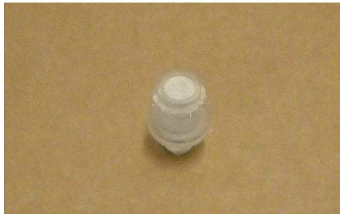
Figura A.3 Malla colocada para convertir el flujo a laminar
