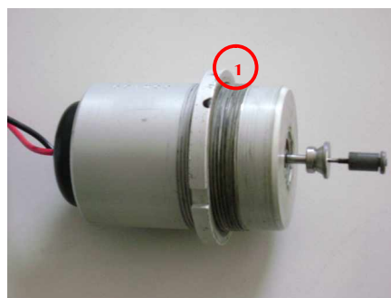
Figura C.4 Servoválvula proporcional 1. Rosca para ajuste
