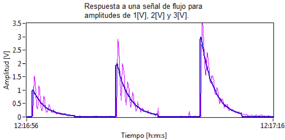
Gráfica R.6 Respuesta a una señal de flujo para amplitudes de 1 [V], 2 [V] y 3 [V] y una frecuencia aproximada de 0.14 [Hz]
