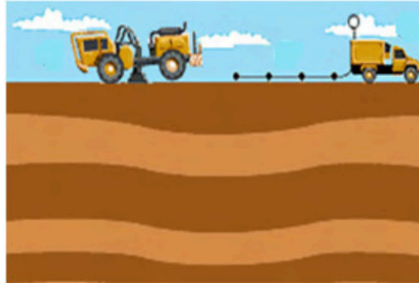
Figura 2.2-5 Exploración en tierra a través de geófonos y sensores remotos (emisión y captura de señales sísmicas).
