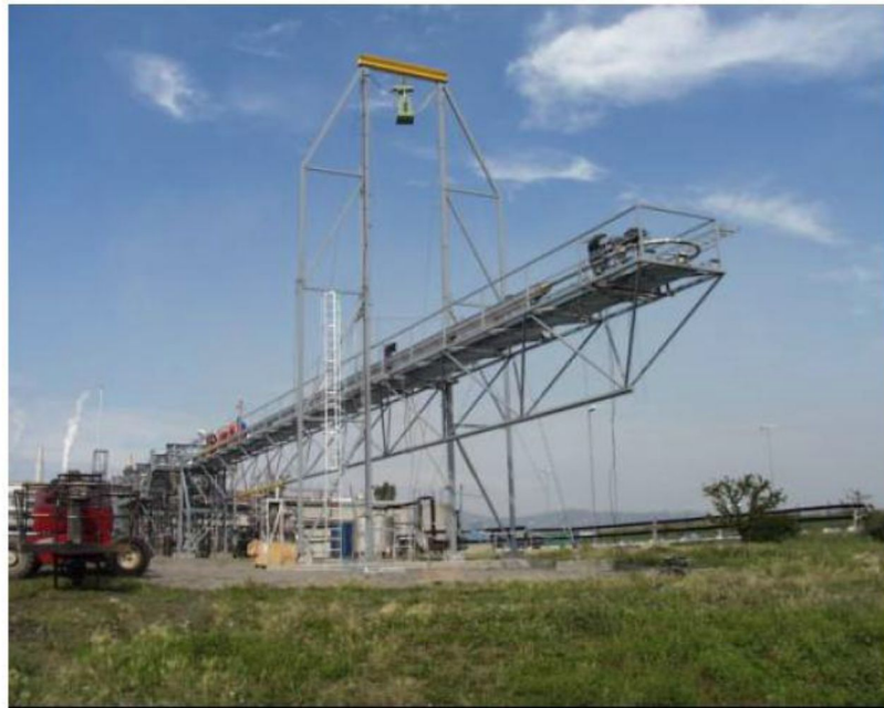
Figura N° 1: Fotografía de la Sección Inclinable del Circuito de Flujo Multifásico. (Mostrado en posición horizontal.)
