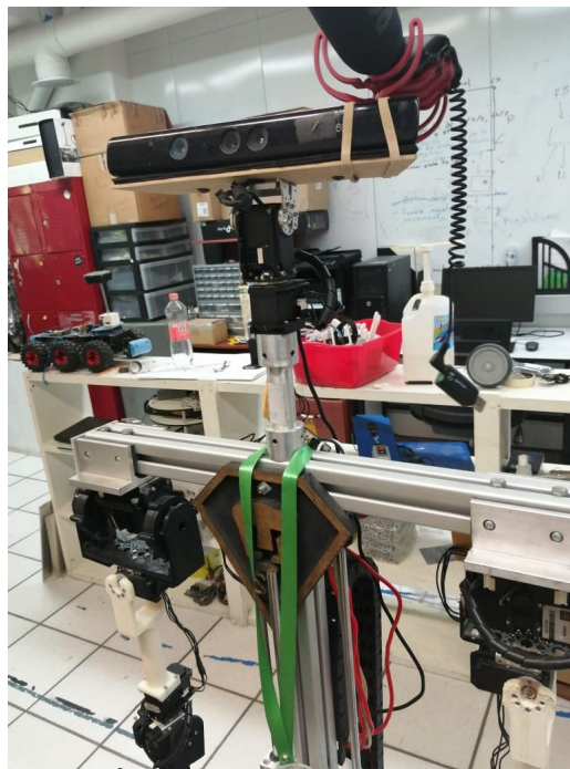
Figura 3.2: Sistema Kinect montado en la cabeza del robot Justina.
