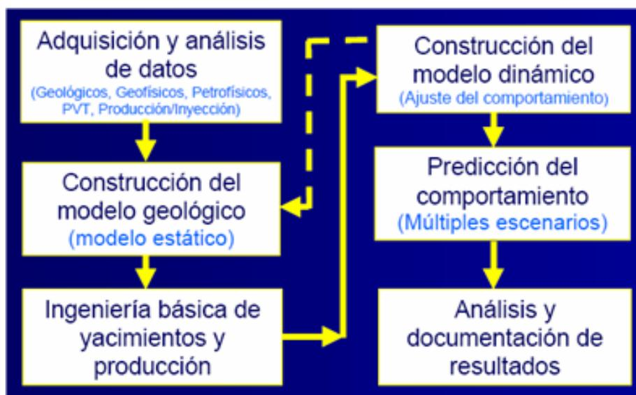
Fig. No. 1 Diagrama esquemático del proceso de simulación numérica de yacimientos.
