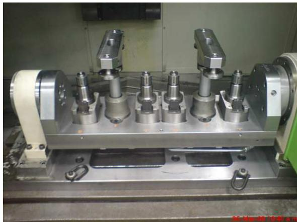
Foto 26: Dispositivo de sujeción, Op. 60
