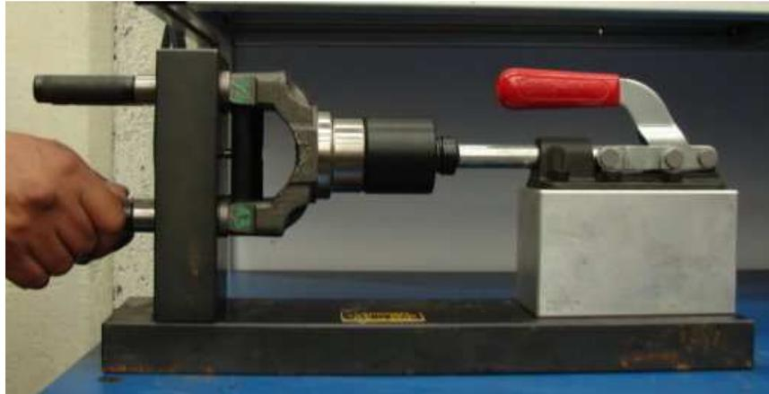
Foto 44: *Gage* para verificar posición verdadera de barrenos
