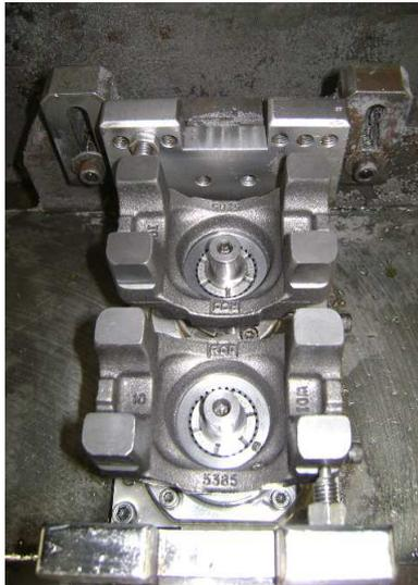
Foto 16: Dispositivo de sujeción, Op. 50/60 con piezas. Amabas tocando el perno de referencia.
