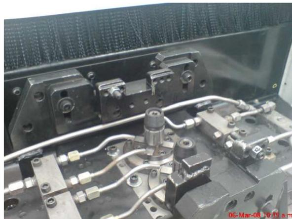
Foto 25: Dispositivo de sujeción, Op. 50.
