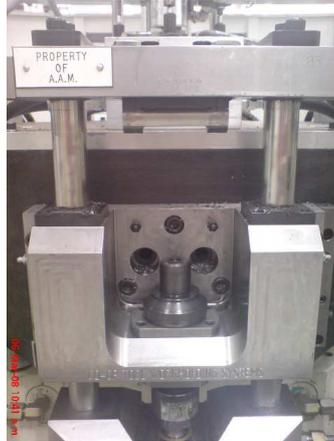
Foto 27: Dispositivo de sujeción, Op. 70.
