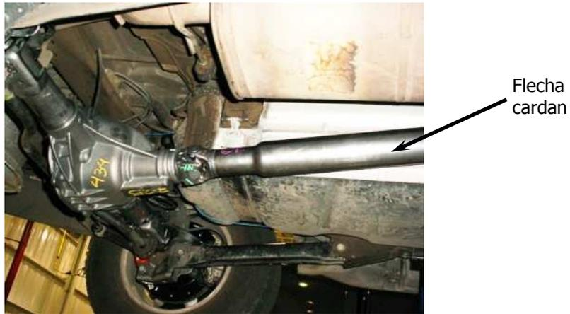
Foto 2: Parte inferior trasera de un vehículo
