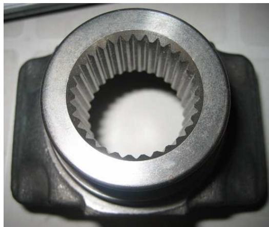
Foto 37: Geometría de estriado (spline)
