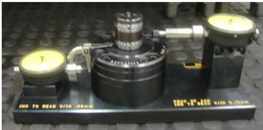
Foto 45: *Gage* para *runout* radial y lateral
