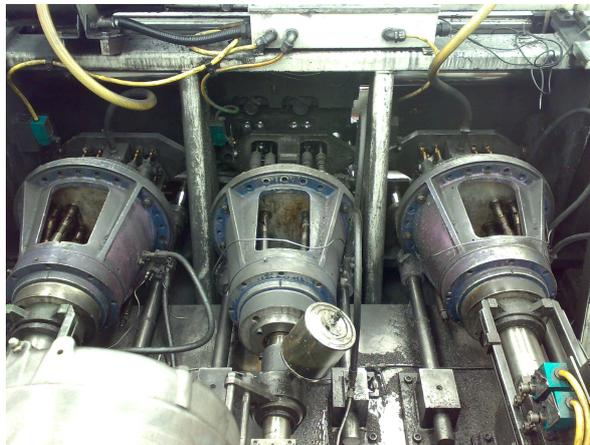
Foto 18: Vista trasera de las 3 estaciones. De izquierda a derecha: Barreno pasado, machueado, barreno de caja.
