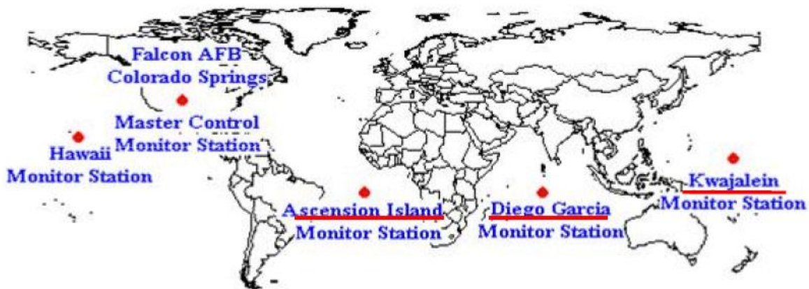
Figura 46. Control maestro y red de estaciones de monitoreo del Sistema Global de Posicionamiento (GPS)
