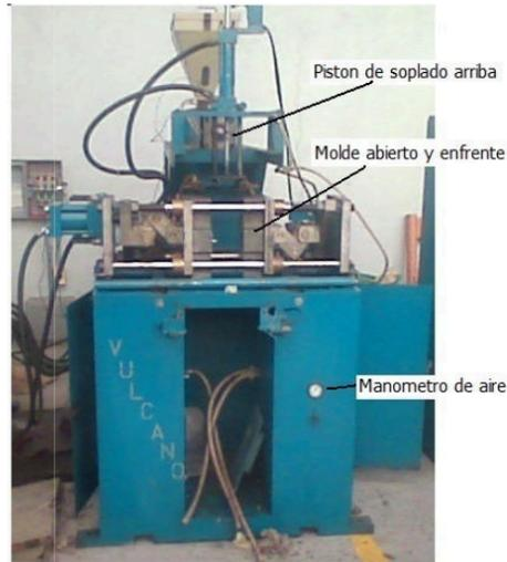
**Máquina de Extrusión Soplado Vulcano**
