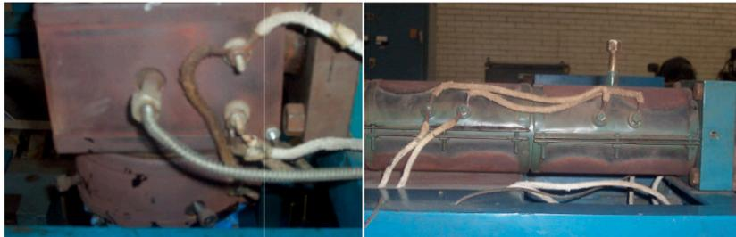
Imagen 3.18: Resistencias eléctricas en el cabezal y cañón.
