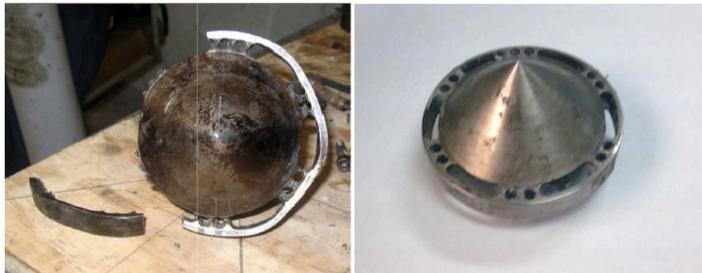
*Imagen 3.30: Distribuidor de flujo original y el fabricado en los talleres de Ingeniería Mecánica*
