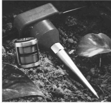
Figura 2.11 Geófono usado para registrar las ondas reflejadas del subsuelo.
