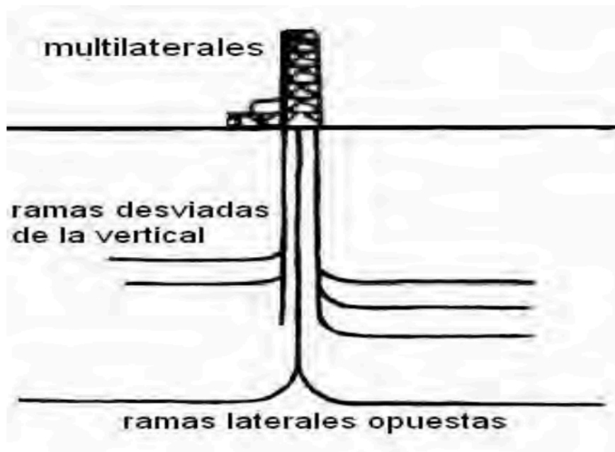
Fig. I.8 Algunas de las formas que puede adoptar un pozo multilateral
