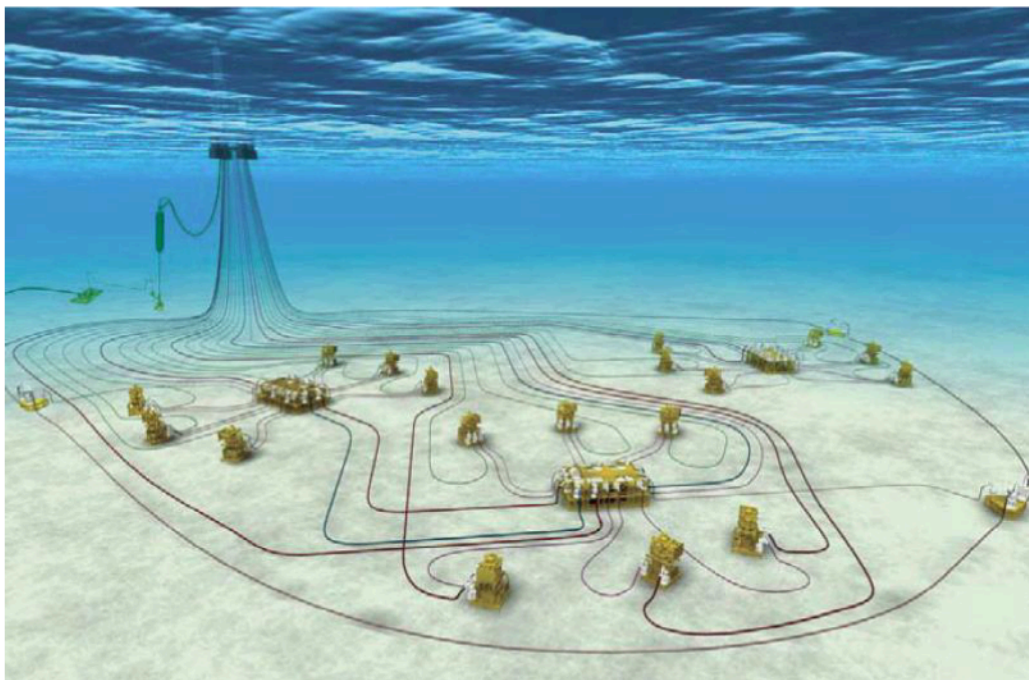
Fig. 4.10 Estado del arte del campo Roncador, anillo de levantamiento por gas, con dos líneas de un lado de la plataforma, con el gas a inyectar conectadas a los tres múltiples. 97
