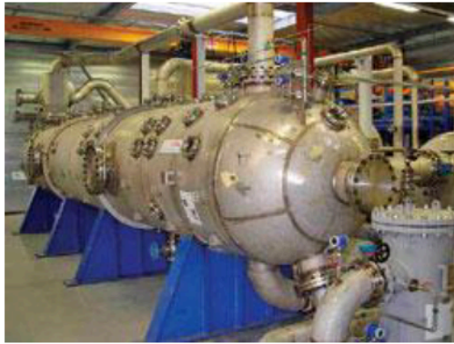
Fig. 1.9 Separador submarino, diseñado por FMC y CDS Engineering en colaboración con Statoil. 23
