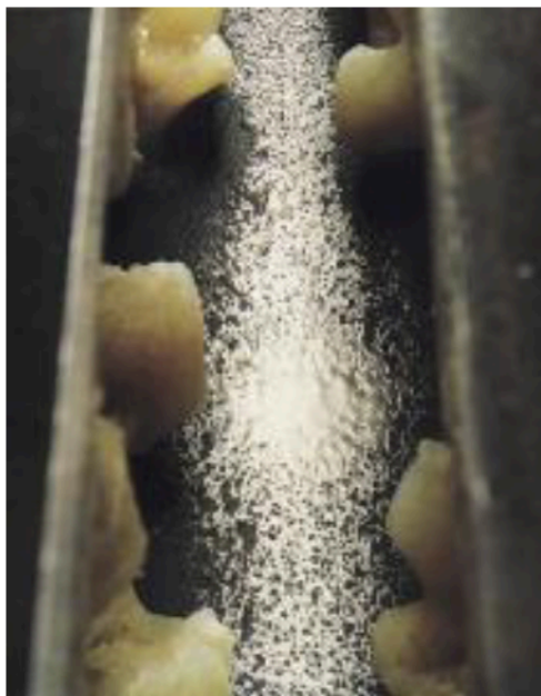
Fig. 2.12 Incrustaciones eliminadas con el abrasivo Sterling Beads. El tubo recibió un solo chorro de agua con Sterling Beads a razón de 2,4 pulg./min [1 mm/seg] para eliminar las incrustaciones de carbonatos. Durante el ensayo, se mantuvo el chorro en la misma posición durante 3 minutos, y menos del 2% del acero fue removido de las paredes del tubo. 69
