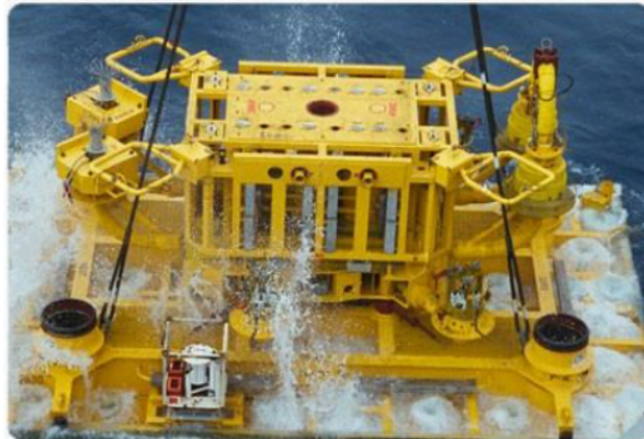
Fig. 1.16 Módulo de Múltiples de Válvulas. 38
