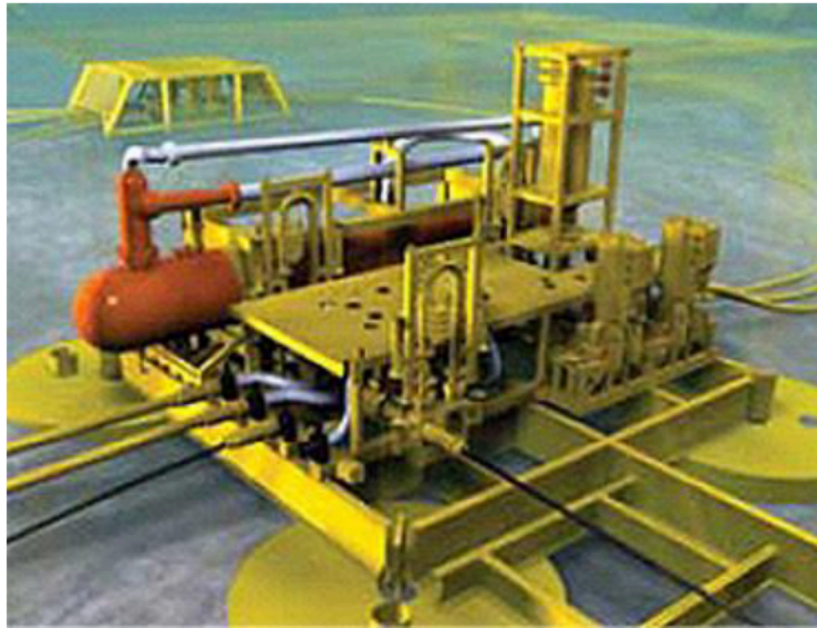
Fig. 4.3 Estación de separación submarina está equipada con dos medidores multifásicos. 89
