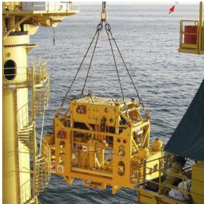
Fig. 1.2 Bomba multifásica de tornillos gemelos AkerKvaerner, la MultiBooster, está instalada en 450 (pies) de agua en el campo Balmoral. 7
