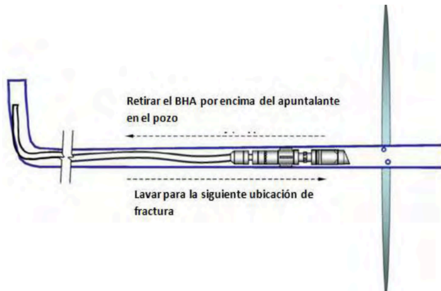
Fig. 3.13— Después de que la etapa de fracturamiento está completa, el BHA es retirado por encima de cualquier apuntalante sobrante en el pozo. Luego el apuntalante es circulado fuera del pozo mientras el BHA se mueve hacia otra ubicación de interés.
