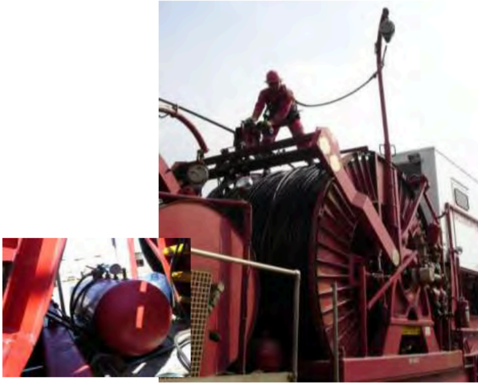
Fig.2.4. Tambor, level wind, swivel, contador mecánico, lubricador de la tubería.
