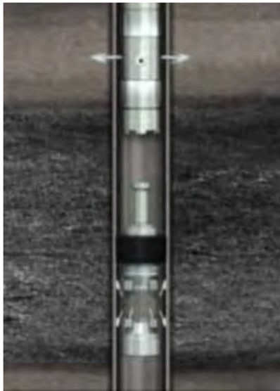
a) Se coloca empacador y se fractura
