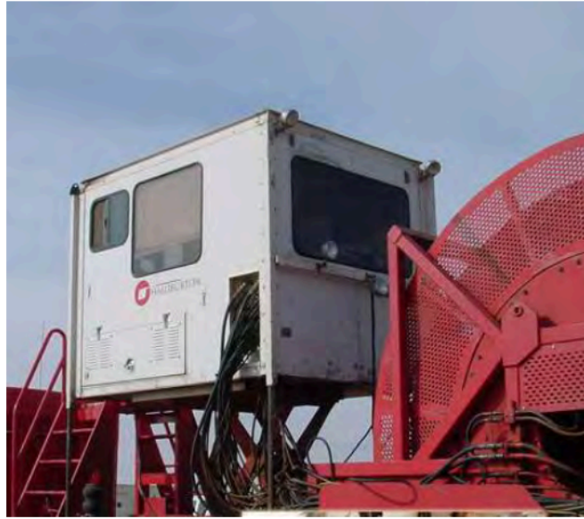
Fig. 2.5. Cabina de control
