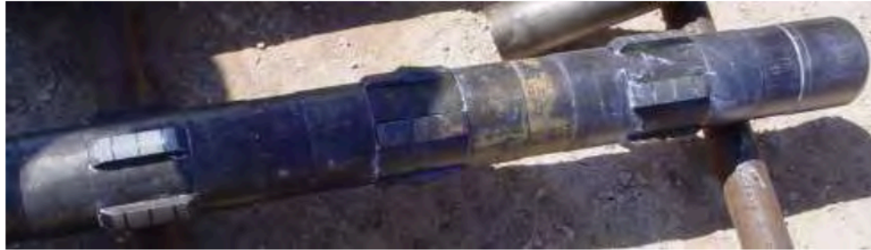
Fig. 3.8. Registrador de coples (CCL)
