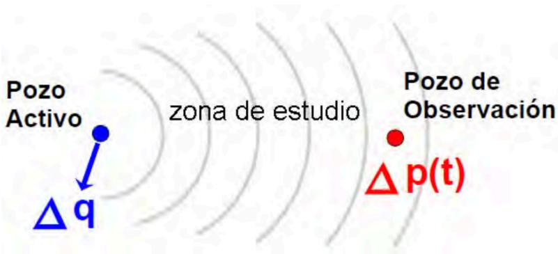
Figura 1.3. Zona de Estudio para una Prueba de Interferencia
