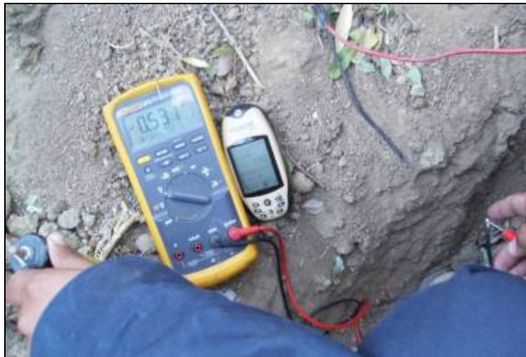
Figura 18: Lectura de un potencial natural después de hacer un despunteo entre el isobutano de 6” y el poliducto de 16” de diámetro.
