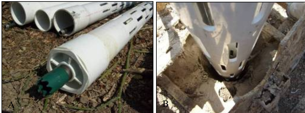
Figura 26: a) Válvula de distribución de coque, b) Sección activa del encamisado.
