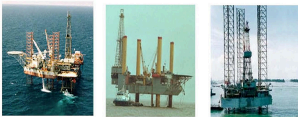
Figura 4.4 unidades de perforación autoelevables.
