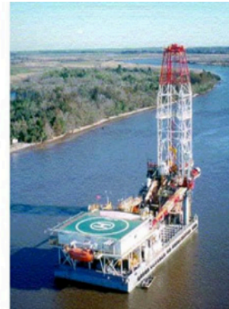
4.3 plataformas sumergibles conocidas como barcazas (chalanas).
