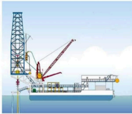
4.3 plataformas sumergibles conocidas como barcazas (chalanas).
