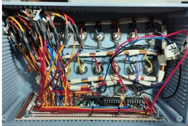
Figura 4.38 Módulo de inversores individuales alambrado
