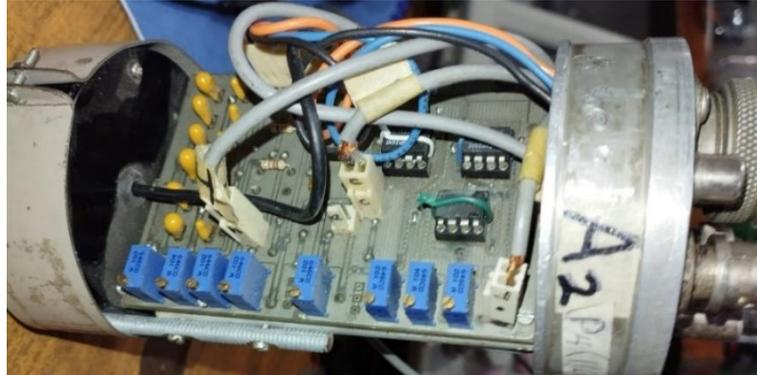
Figura 4.23 Foto del preamplificador – discriminador.
