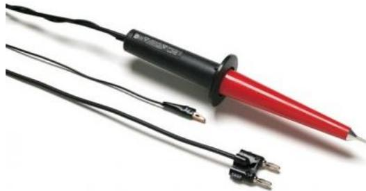
Figura 4.5 Punta HV utilizada [33]
