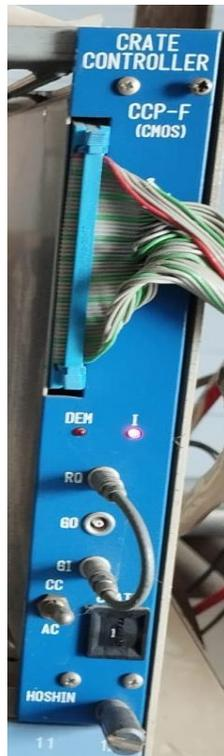
Figura 5.1 Crate Controller utilizado
