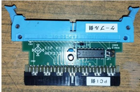
Figura 5.3 Adaptador tarjeta PCI
