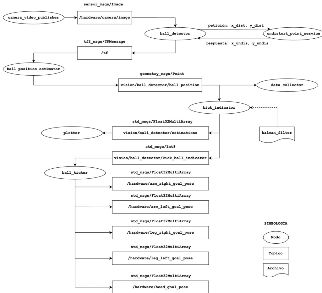
Figura 5.7: Grupo de nodos, tópicos y servicios que constituyen el sistema de visión computacional.
