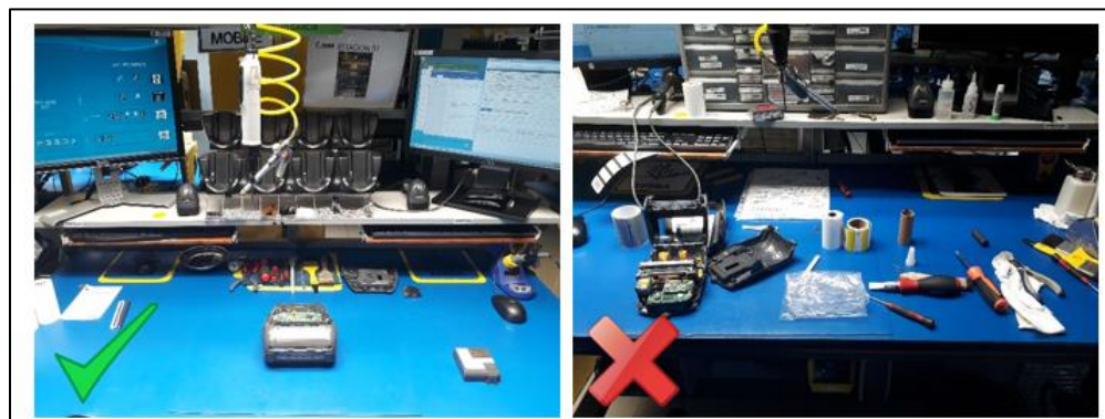
Figura 4. área limpia. Reproducida de normativa ESD de la empresa, 2023. Reproducida con permiso del autor.
