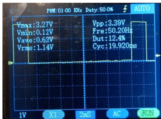
Figura 5.20: Medición en un osciloscopio de la señal PWM generada por el registro correspondiente, en dónde se conectaría el servomotor, con un ciclo de trabajo de 12.4%. Se mantiene el pulso de señal del servo en estado alto 2 milisegundos, lo que genera un movimiento del servo a la posición de 180^\circ . [30]
