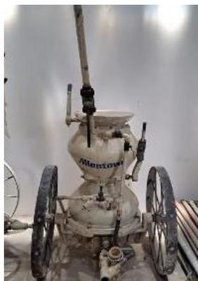
Figura 4.8. Gunitadora de concreto refractario. Fuente: Propia.
