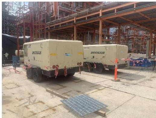
Figura 4.10. Compresores neumáticos de 750 CFM. Fuente: Propia
