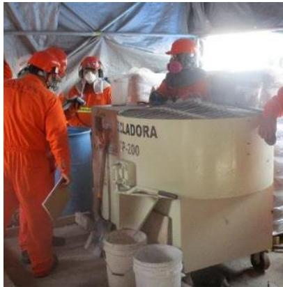
Figura 4.9. Mezcladora de concreto refractario. Fuente: Propia
