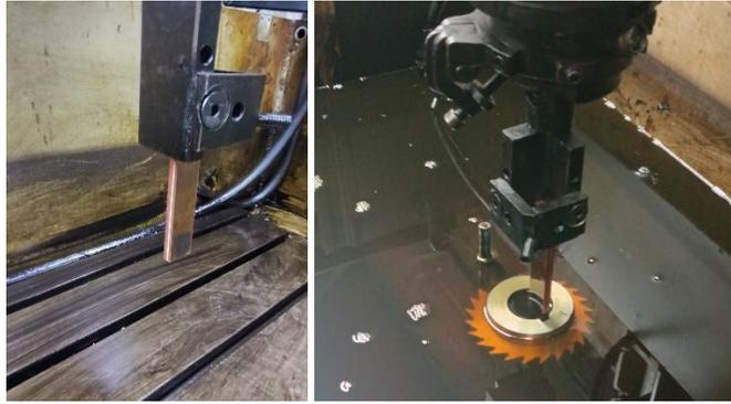
*Figura 3.53 Maquinado del cuñero por electroerosión.*
