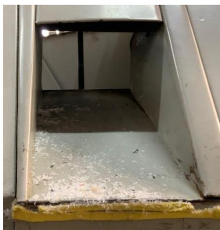
*Figura 2.12 Descarga de material ineficiente.*
