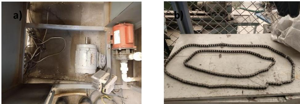
Figura 2.20 a) motor del sistema motriz. b) cadenas motrices.
