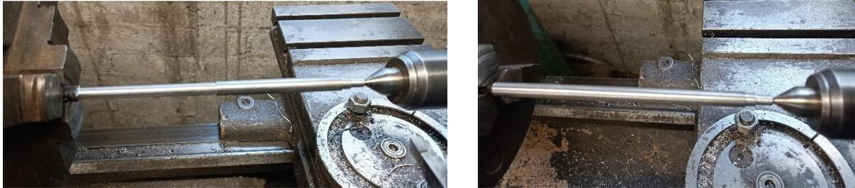
*Figura 3.32 Fabricación de ejes del sistema de alimentación.*
