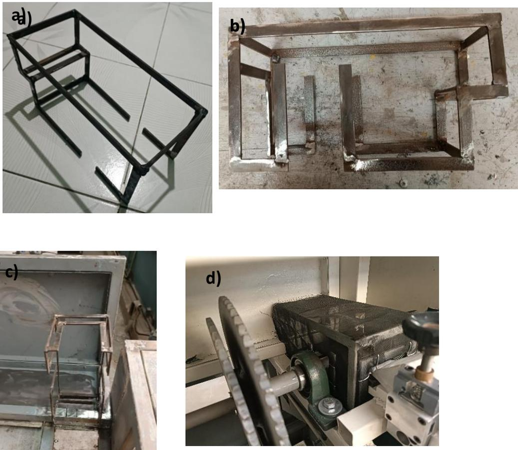
*Figura 3.10 a), b) fabricación de la cubierta. c) cubierta montada en la unidad móvil. d) apariencia final de la cubierta.*
