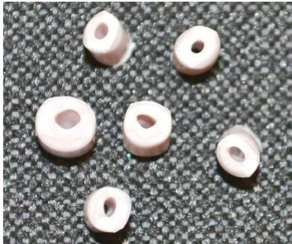
*Figura 1.15 vacíos en pellets. [18]*
