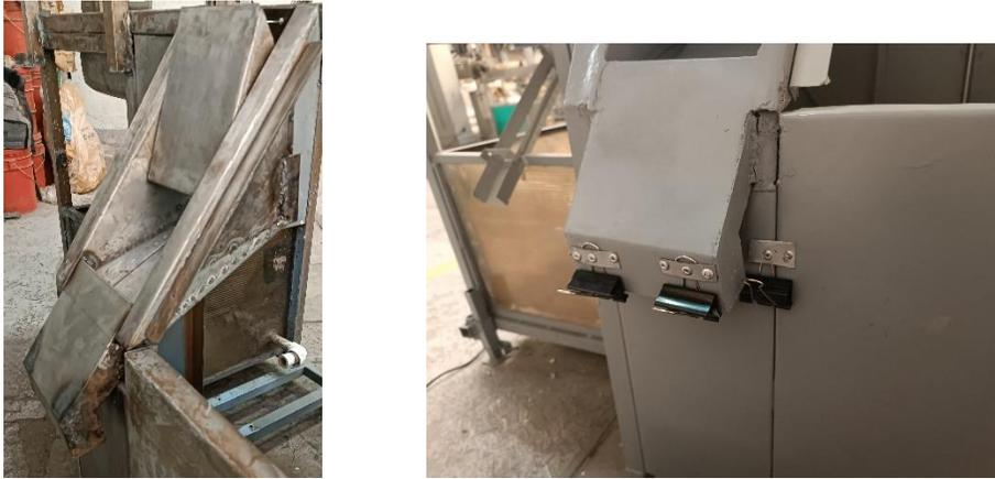
*Figura 3.20 Sistema de descarga inferior con salida de material modificada.*
