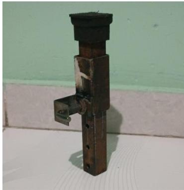
*Figura 3.6 Soporte regulador de altura ensamblado.*
