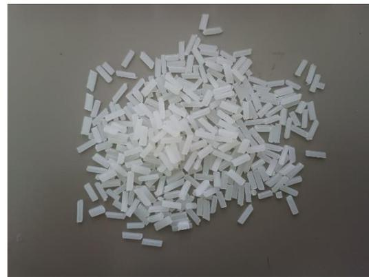
Figura 4.3 a) Muestra de pellets con velocidad relativa de 30%. b) Muestra de pellets con velocidad relativa de 40%
