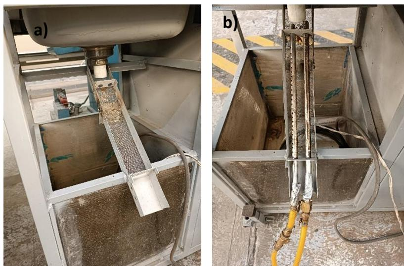
*Figura 3.26 a) Sistema de descarga de peletizado en caliente montado. b) Sopladores en el sistema de descarga.*
