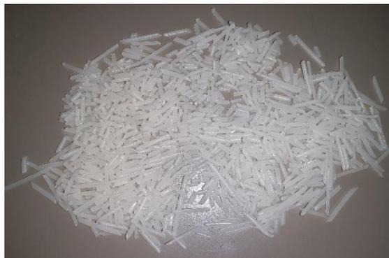
Figura 4.5 Muestra de pellets con velocidad relativa de 75%.
