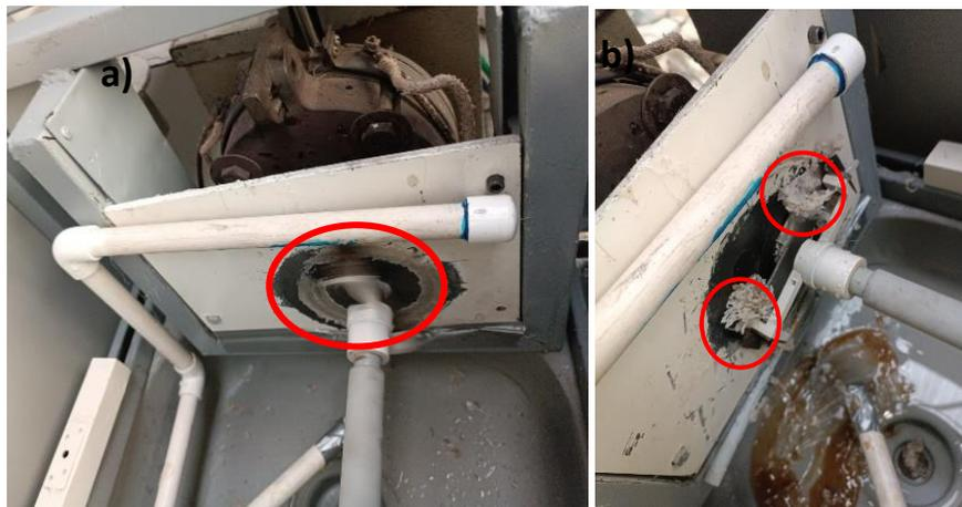
Figura 4.13 Defectos en el pelletizado en caliente.
