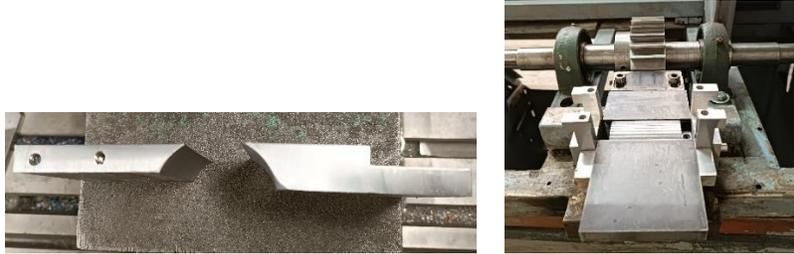
*Figura 3.37 Modificación de la base del sistema de alimentación.*
