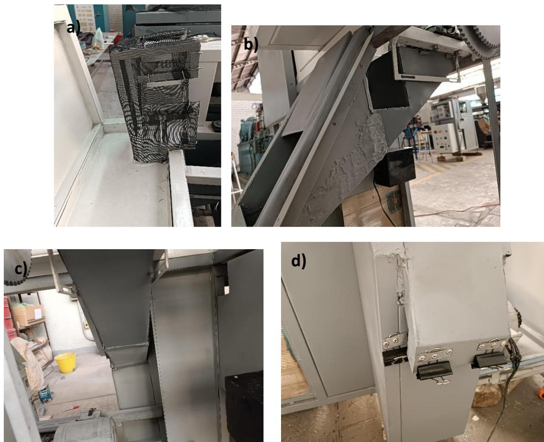
*Figura 3.22 Modificaciones al sistema de recolección y descarga. a) Sistema de recolección. b) Unión entre sistemas de descarga. c) Sistema de descarga inferior. d) Salida de material.*
