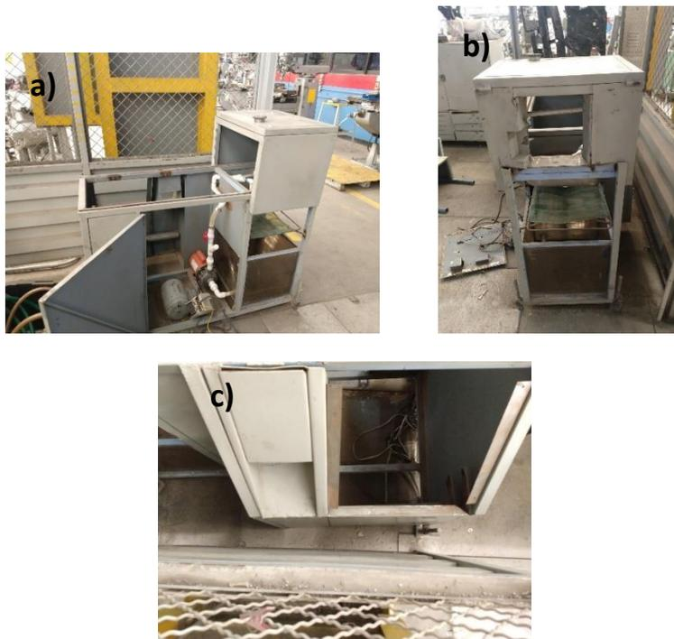
Figura 2.21 a) Lado de la máquina del peletizado en frío. b) Lado de la máquina de peletizado en caliente. c) Descarga de material y panel de control.
