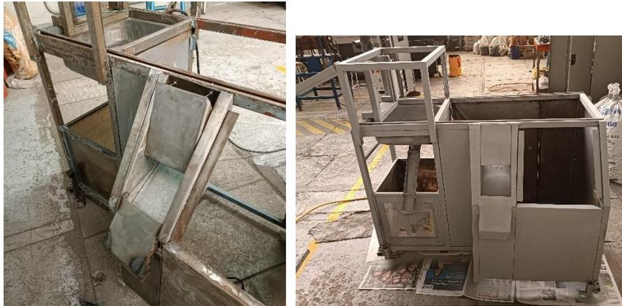
*Figura 3.43 Trabajos de reacondicionamiento en el sistema de descarga inferior.*
