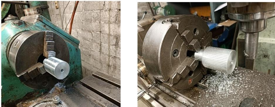
*Figura 3.33 Fabricación del rodillo inferior.*
