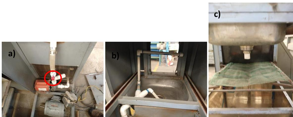
Figura 2.22 Sistema de enfriamiento. a) boba de agua. b) sistema de spray. c) sistema de descarga
