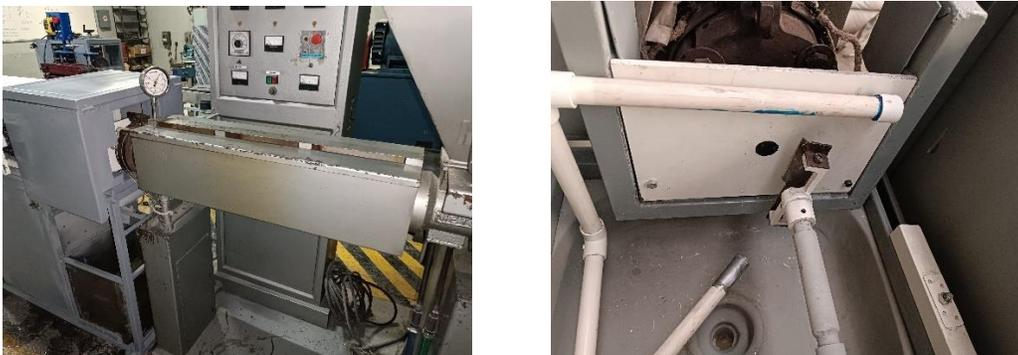
*Figura 4.11 a) Línea de producción peletizado en caliente. b) Peletizadora acoplada con extrusora*
