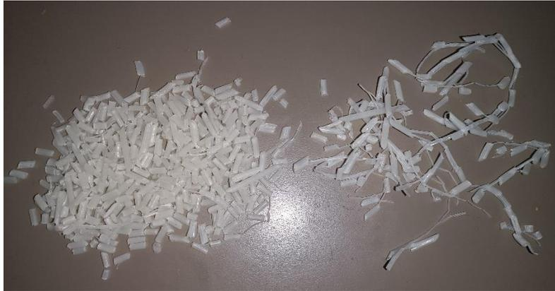
*Figura 4.6 Muestra de pellets con velocidad relativa de 100%.*
