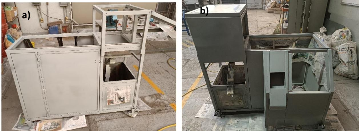
*Figura 3.44 Trabajo de pintado en la estructura fija. a) Capa de pintura primaria. b) Capa de pintura acrílica.*
