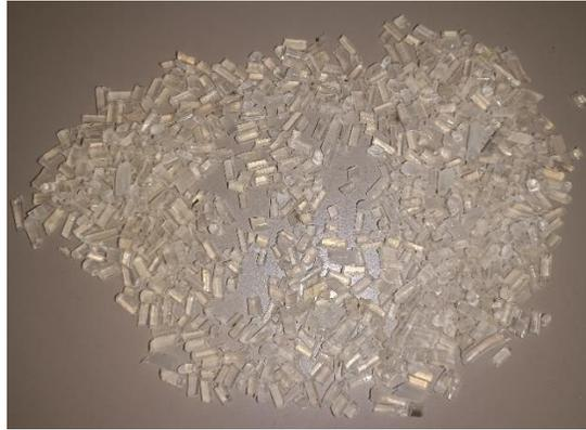
Figura 4.8 Muestra de pellets de PLA.
