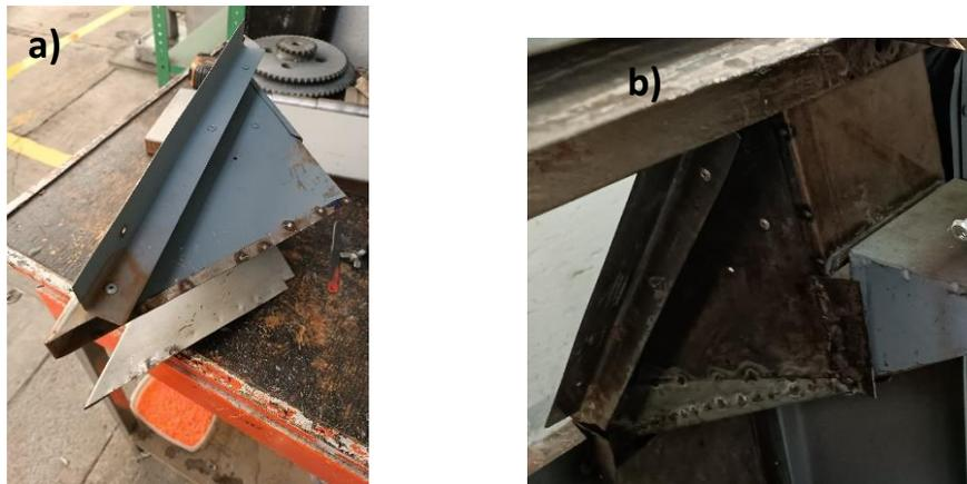
Figura 3.17 Fabricación del cambio de ángulo en la rampa inferior. a) base de la rampa desmontada. b) resultado del cambio de ángulo.
