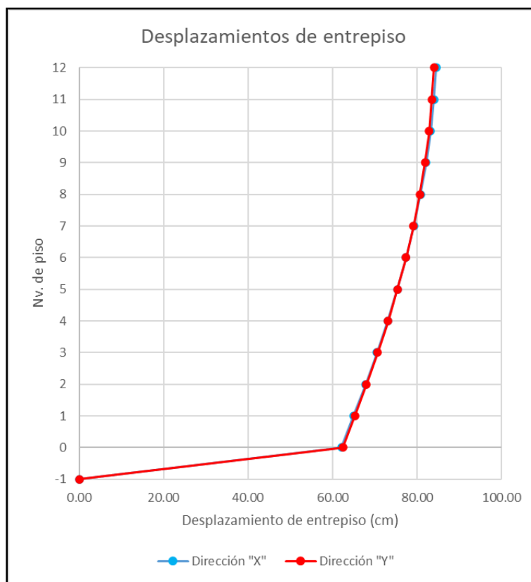
Imagen 59. Gráfica de desplazamientos de entrepiso (Estructura aislada).
