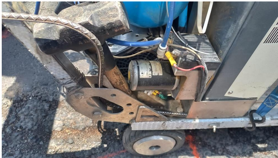
Figura 37. Bomba de vacío.
