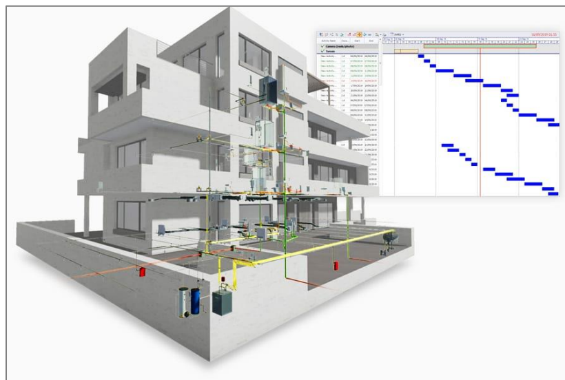
Ilustración 4. 9. Ejemplo de configurador paramétrico de objetos MEP.
