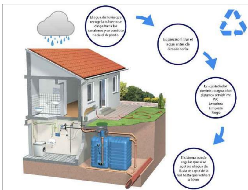
Ilustración 1. 12. Sistema para aprovechamiento pluvial.
