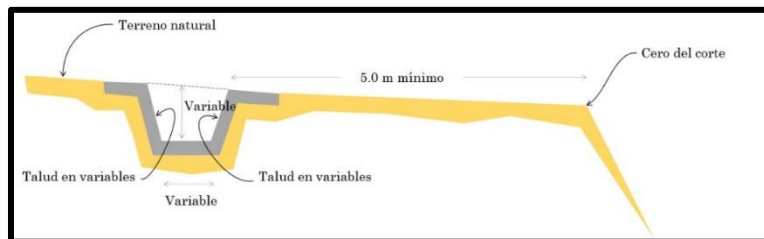
Figura 5. Sección tipo de contracuneta.
