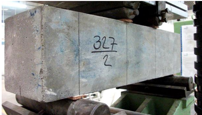
Figura 9 Prueba de Resistencia a la Flexión de Viga Simple
