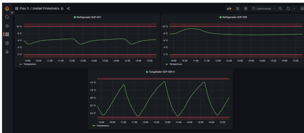
Imagen 5. Interfaz en Grafana. Se visualizan las señales de temperatura y los límites de temperatura del rango de operación
