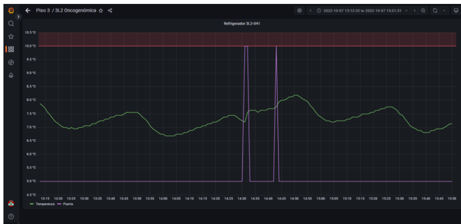
Imagen 7. Señal de puerta. Se aprecia un aumento de temperatura por uso del equipo.
