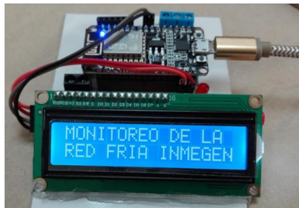
Imagen 3. Funcionamiento del módulo de medición con LCD integrada
