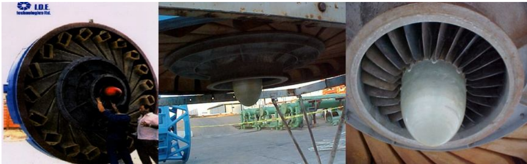
Figura 2.3 Compresor mecánico del proceso de desalación MVC. [www.ide-tech.com]
