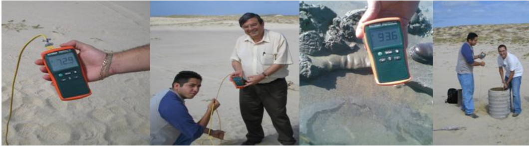
Figura 2.7 Toma de temperatura en los pozos perforados en la Península de Baja California. [www.impulsa4.com]
