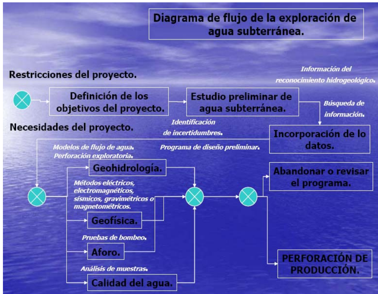
Figura 5.3. Diagrama de flujo de la exploración de agua subterránea.
