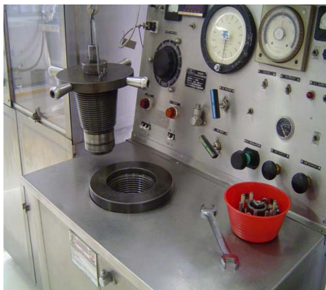
Consistómetro presurizado para medir el tiempo bombeable.
