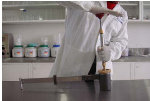
Presurización con la bomba
