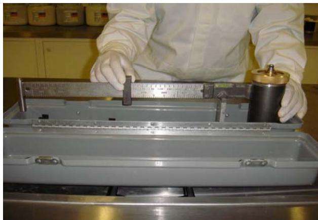
Determinación de la densidad de la lechada
