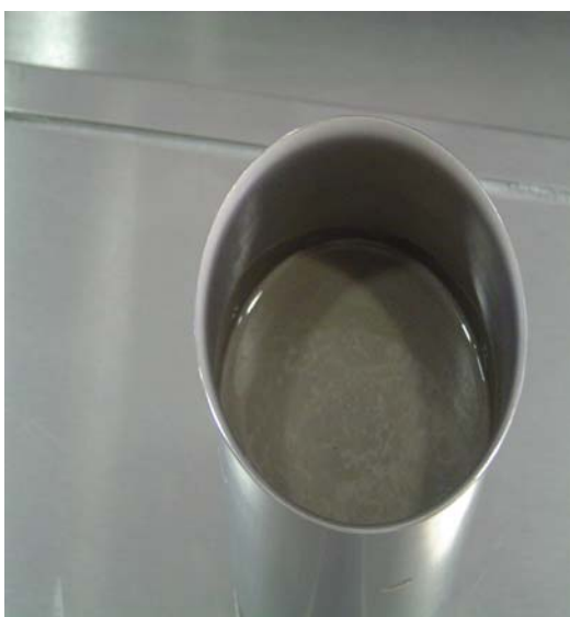
Lechada en el vaso del consistómetro
