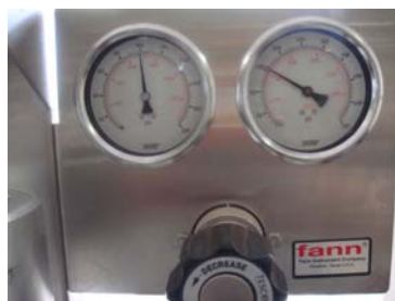
Presión en el filtro - prensa (1000 psi)
