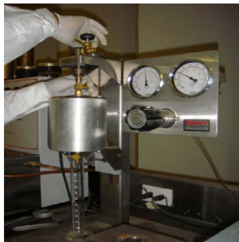
Inicio de la prueba de filtrado.
