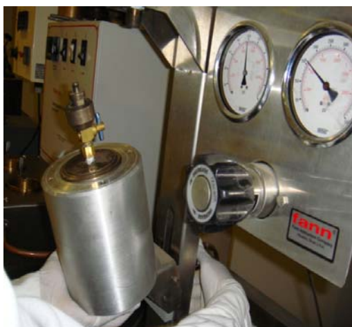
Conexión del sistema presurizado.
