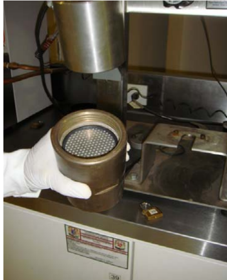
Colocación de la malla #325.
